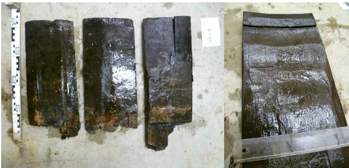
Figuur 101: Eikenhouten duigen met bewerkingssporen aan de binnenkant (zie detail rechts; vnr. 301).
