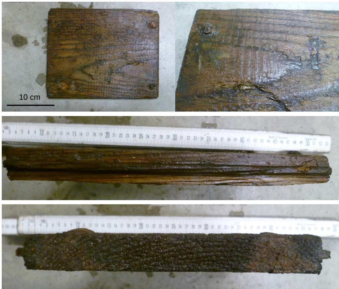
Figuur 58. Vnr. 96: Plank gemaakt van hout van de zilverspar. Rechtsboven: sporen van machinaal zagen; midden: bovenaanzicht op een mes van de plank; onder: zij aanzicht van de plank met beide messen zichtbaar.
