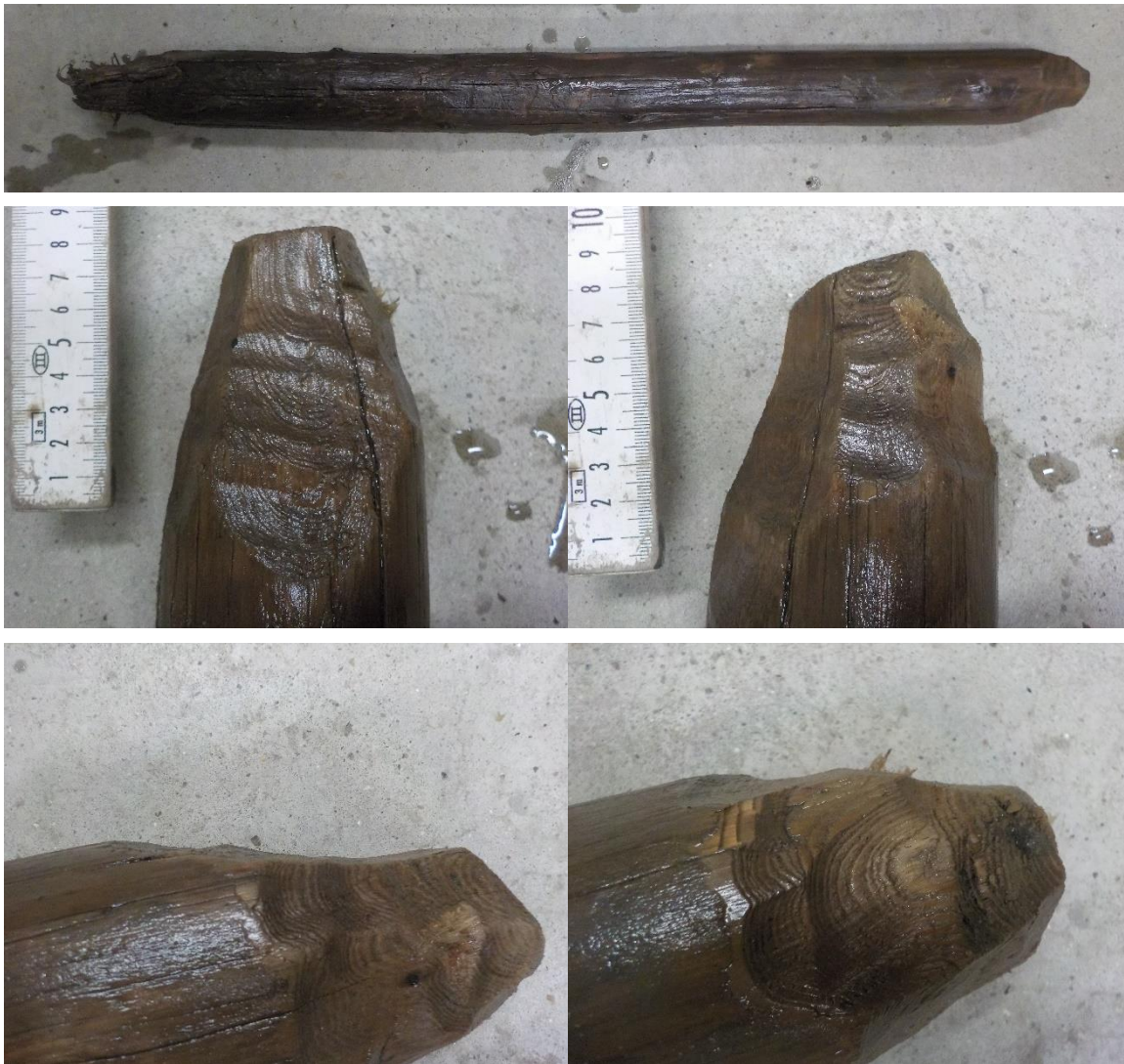
Figuur 52. Vnr. 112: een paal gemaakt van vurenhout waarbij de punt bestaat uit vele kleine kapvlakken.
