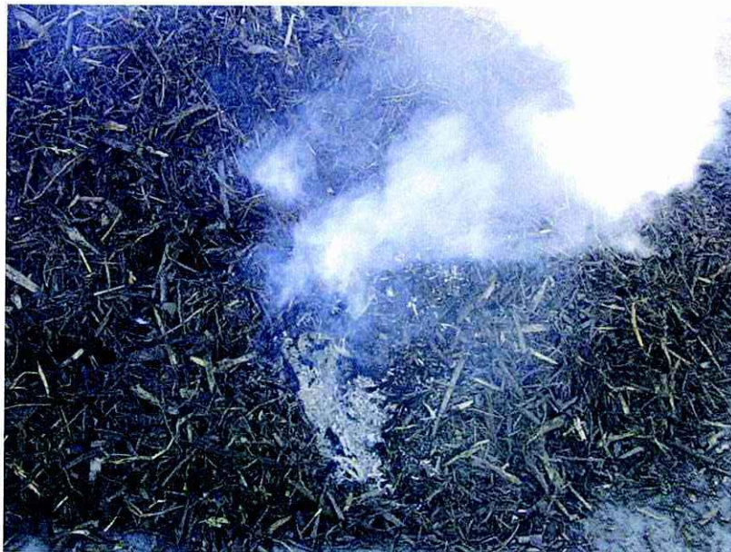
Foto 3658: tijdstip t = 15:28 [m:s] Er is geen sprake van uitbreiding van vlamverschijnselen over het oppervlak van de hoop.
