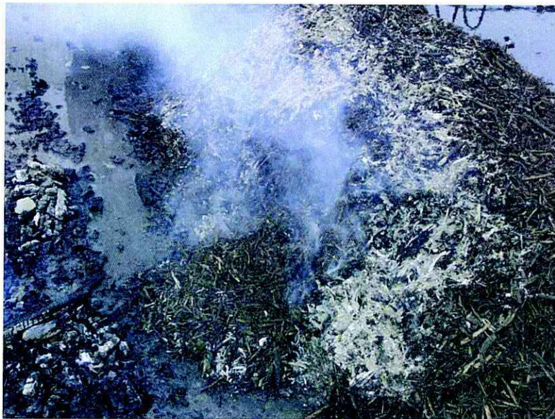
Foto 3685: De vuurkorf is met een heftruck voorzichtig gelift en weggereden. Links is verbrand hout uit de korf zichtbaar. Slechts direct naast de korf is het materiaal op de hoop verbrand door direct vlamcontact. Zelfstandige verspreiding van het vuur heeft niet plaatsgevonden.
