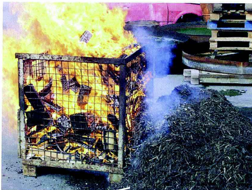
Foto 3673: tijdstip t=8:18 [m:s] Het direct aan de vlammen blootgestelde materiaal verbrandt en kleurt grijs.
