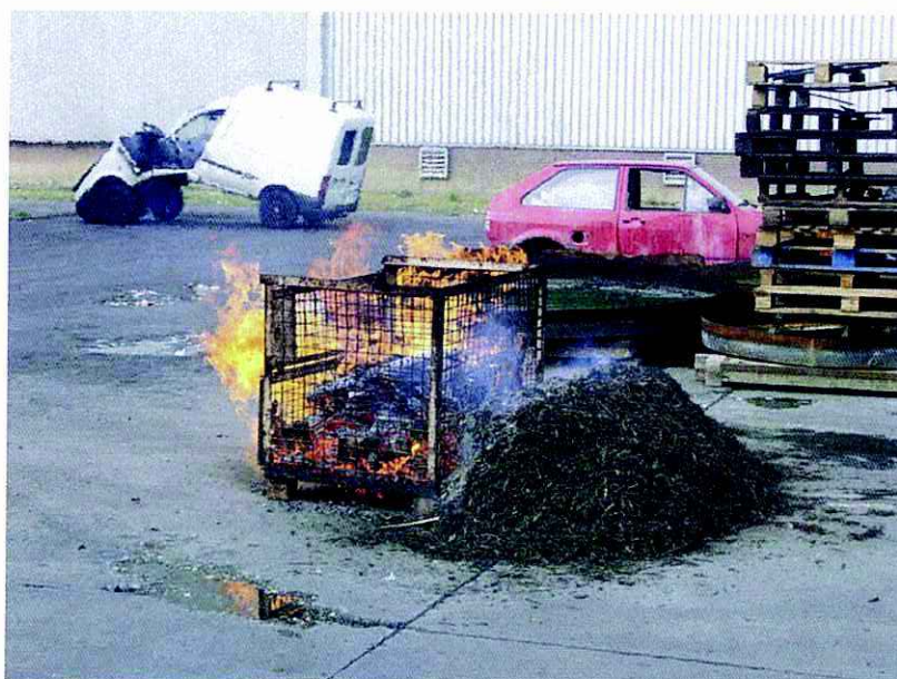
Foto 3681: tijdstip t = 18:02 [m:s] De omvang van het vuur in de korf neemt af. Er zijn geen vlamverschijnselen en geen branduitbreiding op de hoop zichtbaar.
