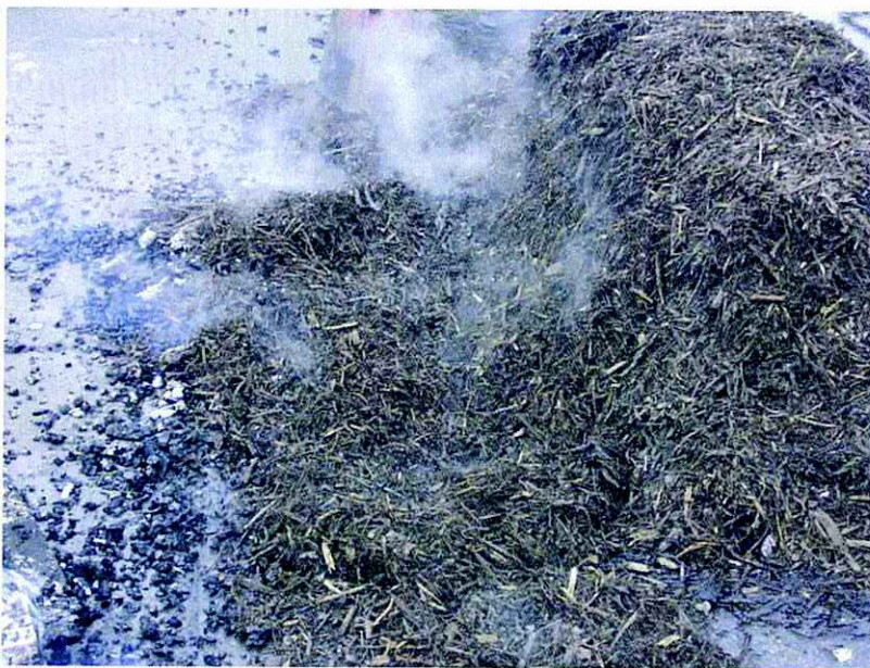
Foto 3687: direct onder de toplaag (hooguit 2 cm dikte) van verbrand materiaal is het materiaal niet aangetast.
