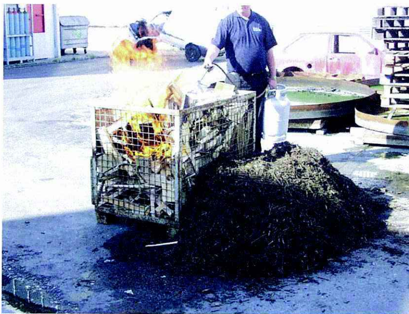
Foto 3666: tijdstip t=0:00 [m:s] Ontsteking van de korf vindt aan twee zijden van de korf plaats, één zijde brandt reeds.
