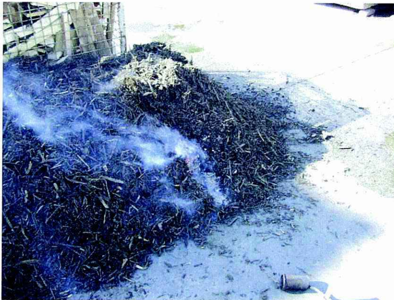
Foto 3660: tijdstip t = 18:32 [m:s] Door droging zijn af en toe vlamverschijnselen zichtbaar aan rand van het smeulende materiaal, er is geen uitbreiding van vlamverschijnselen over het oppervlak van de hoop.
