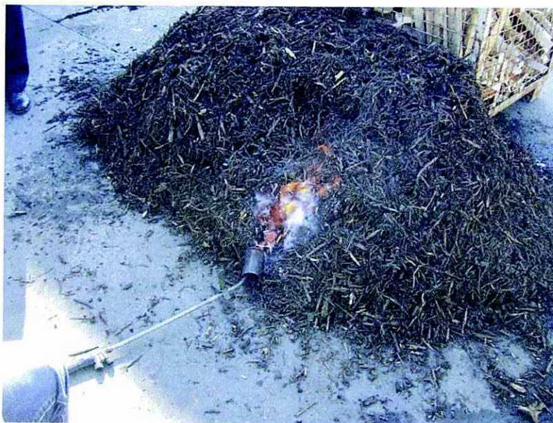
Foto 3652: tijdstip t = 03:48 [m:s] Er is geen uitbreiding van vlamverschijnselen aan het oppervlak van de hoop zichtbaar.
