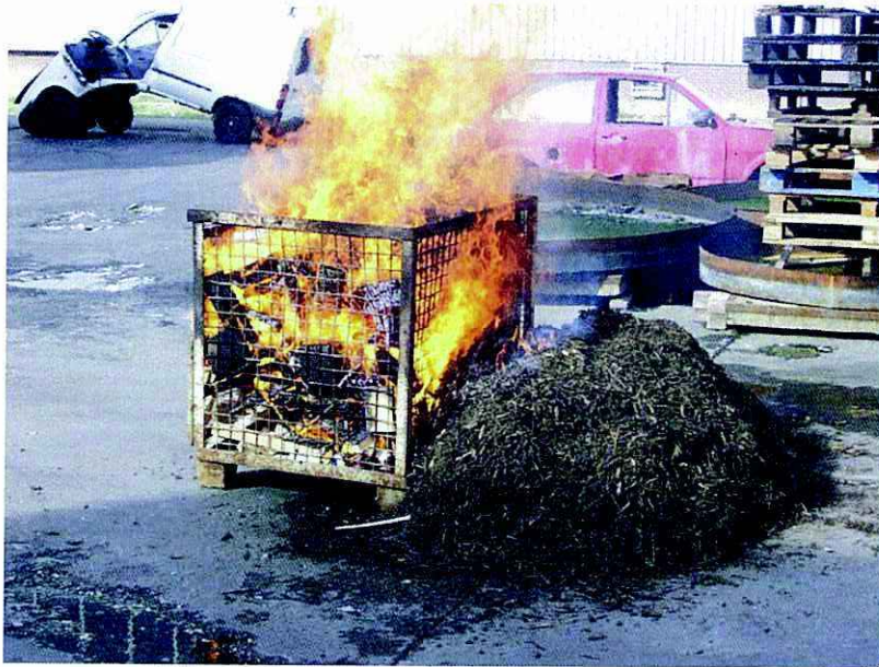
Foto 3670: tijdstip t=6:46 [m:s] Aan de verhitte zijde verdampt het vocht uit het materiaal van de hoop.
