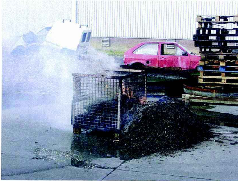
Foto 3673: tijdstip t=20:00 [m:s] Het vuur in de korf wordt geblust met water, de hoop biomassa wordt hierbij niet nat gemaakt.
