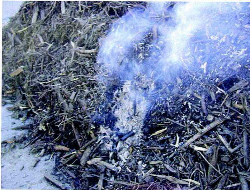
Foto 3655: tijdstip t = 11:28 [m:s] Het materiaal is lokaal weggebrand slechts daar waar de brander heeft gelegen.
