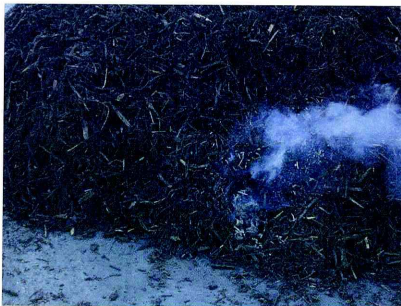
Foto 3653: tijdstip t = 05:22 [m:s] De brander wordt weggehaald, vlamverschijnselen zijn niet zichtbaar, het vocht in het materiaal verdampt door smeulend materiaal.
