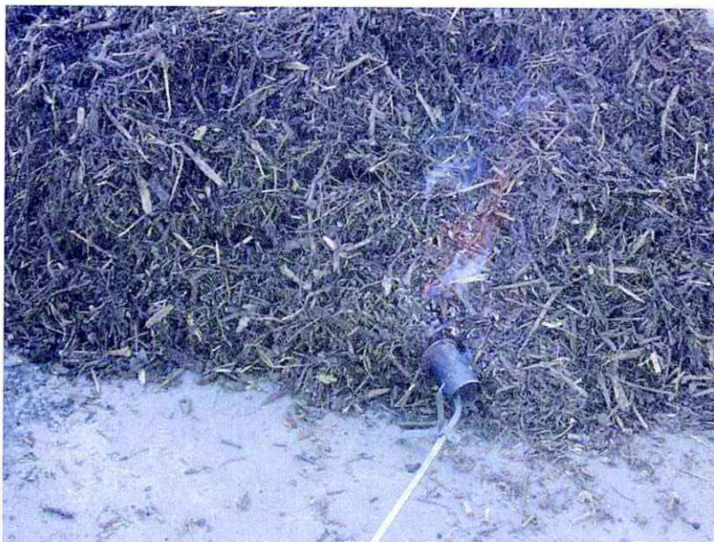
Foto 3649: tijdstip t = 00:00 [m:s] De brander wordt aangestoken en aan de onderzijde van de hoop in het materiaal gelegd.
