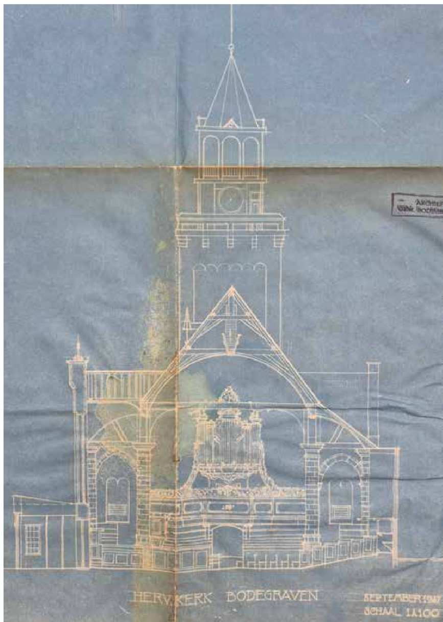
afbeelding 229. Dwars- en langsdoorsnede van de Dorpskerk uit september 1947 van de bestaande toestand, vermoedelijk opgesteld door architect Petri. Bron: RHCVV, toegang B058a, inv.nr.: 95.
