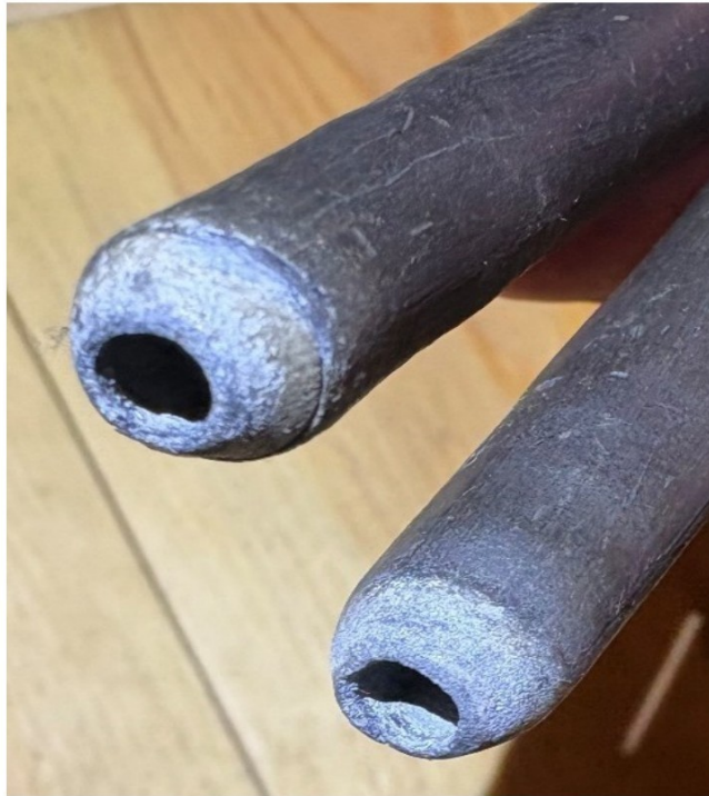
Contactcorrosie Cornet Hoofdwerk
