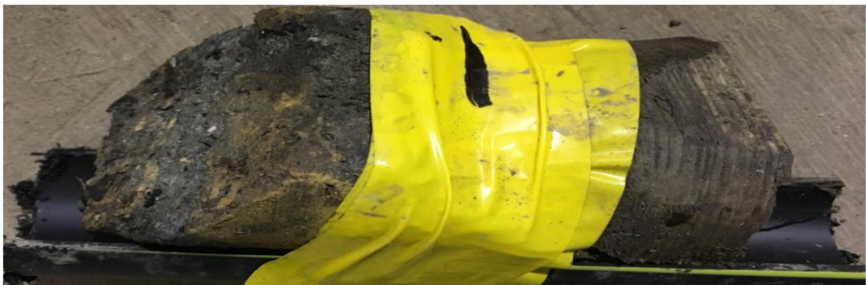
Boorkern 1 schuin door fundering (proefkuip 2)
