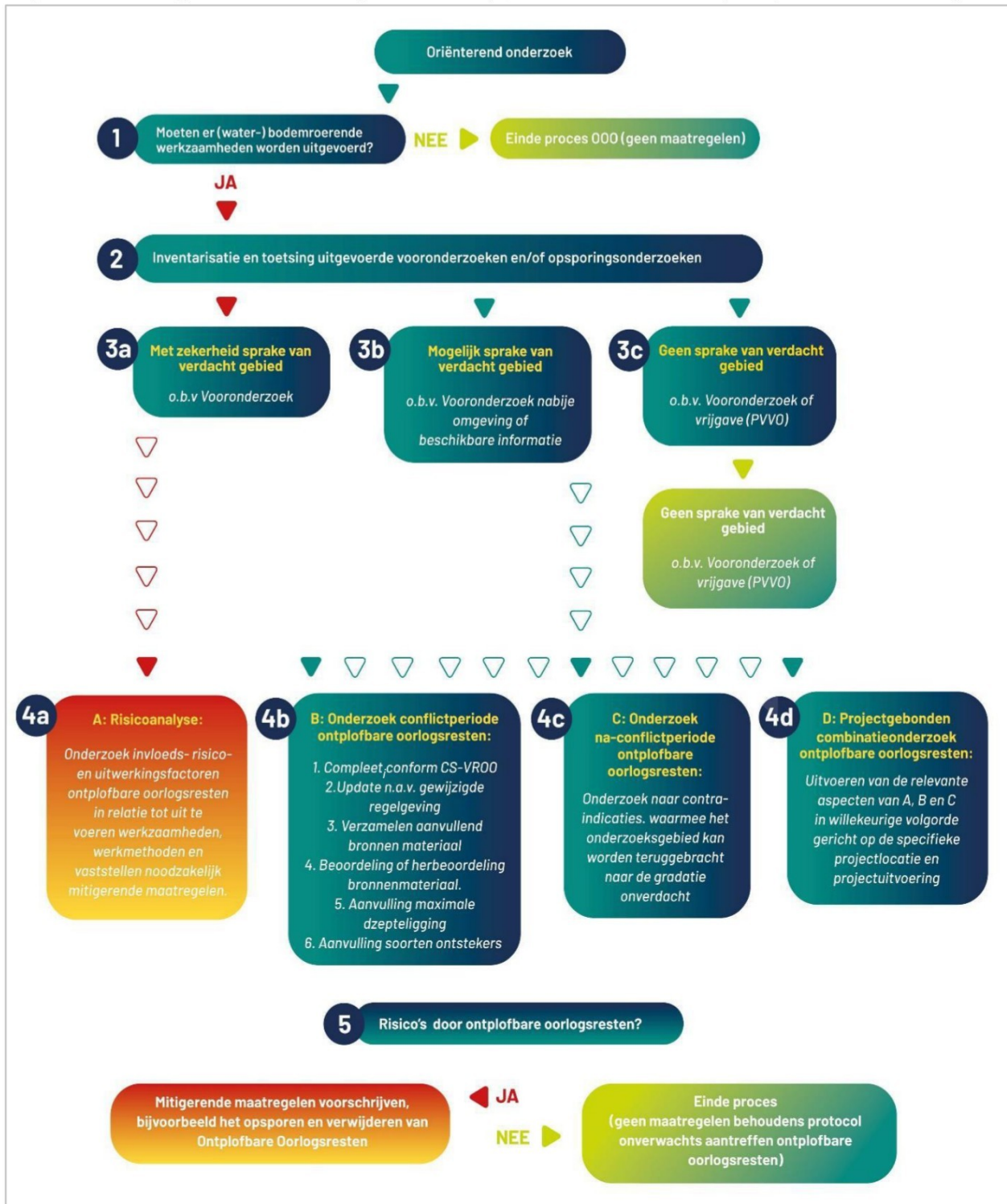
Figuur 1: Processchema RI&E Ontplofbare Oorlogsresten.
