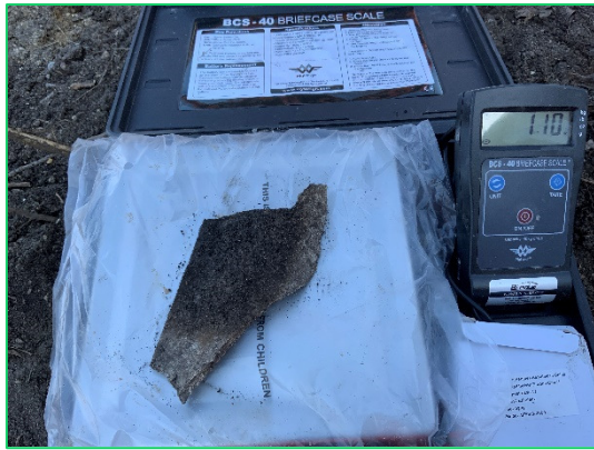
Aangetroffen asbestverdacht plaatmateriaal
